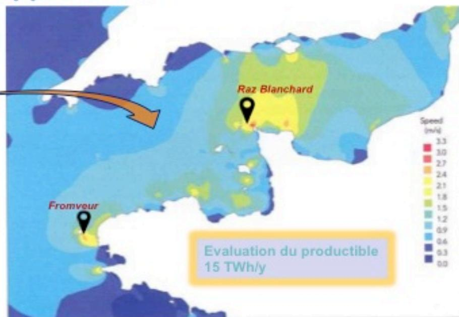
Figure 3 : cartographie de la vitesse maximale du courant de marée en vive-eau moyenne (© EDF : données issues du modèle Télémac EDF/DRD).
